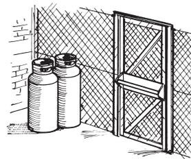
Notausgänge innerhalb des Lagerbereichs müssen leicht erreichbar und in ausreichender Anzahl vorhanden sein. Die Türen der Notausgänge müssen sich in Fluchtrichtung öffnen lassen und dürfen weder von innen noch von
